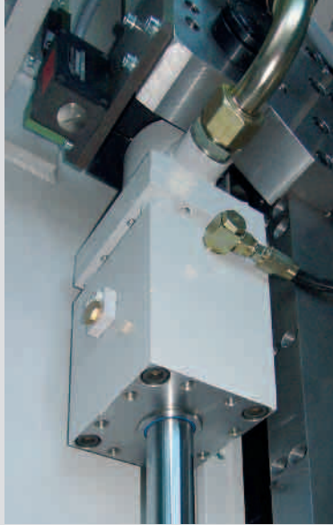
▲ Starker Klemmkopf zur wirkungsvollen Absicherung der Z-Achse bei Stromausfall.
