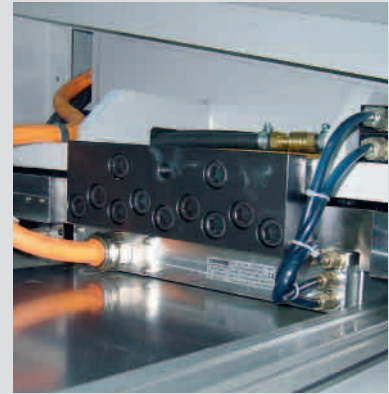
▲ Linearantrieb in der oben liegenden X-Achse.
