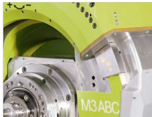
Der Schlüssel zur Realisierbarkeit sind die eigens entwickelten, sehr stabilen und genauen Bogenführungen der B-Achse.
