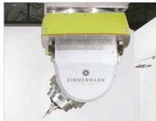
Trotz drei Achsen ist der M3 ABC erstaunlich kompakt.
