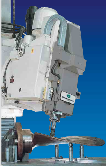
Senkrecht-Fräskopf mit stufenlos \pm 90^\circ schwenkbarer B-Achse.
