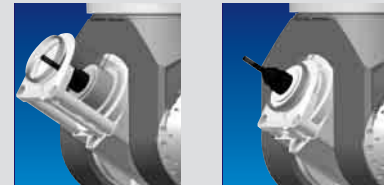
▲ Die NC-gesteuerte Absaugglocke der innenliegenden Absaugung für komplizierteste Konturen.
