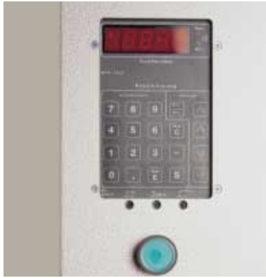
▲ Motorische Tischverstellung. Motor-driven table adjustment.
