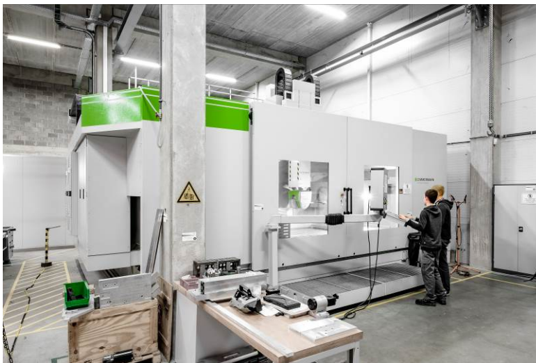
Bild 6: Dafür setzt RapidFit auf eine Portalfräsmaschine FZ33 compact der F. Zimmermann GmbH.
