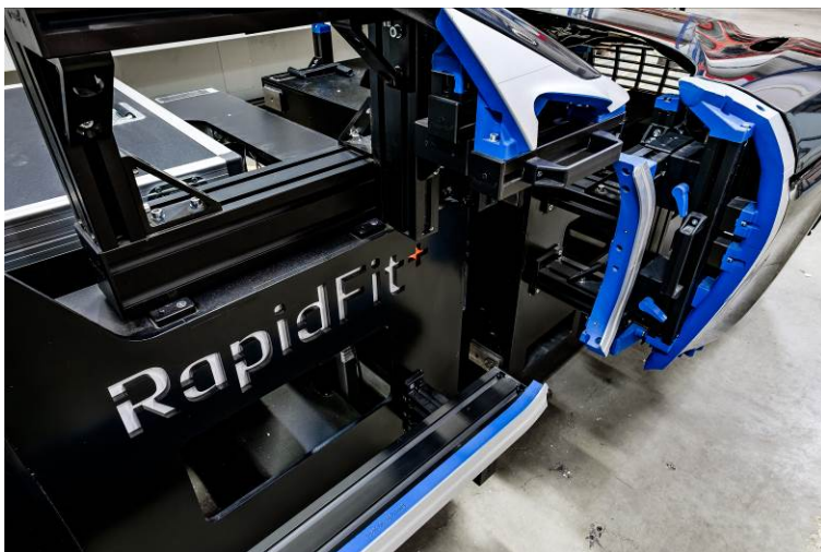
Bild 2: Integriert in diesen Cube sind neben den Baugruppen auch Messaufnahmen, Ausschnittlehren.
