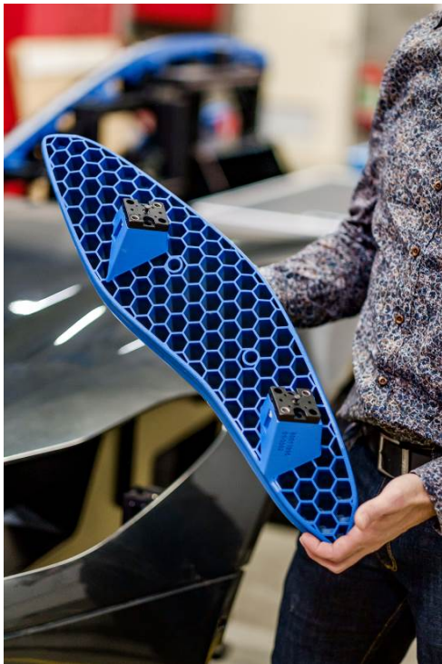
Bild 4: Hergestellt werden die Bauteile additiv im 3D Druck aus Aluminium, Polyamid oder aus speziell entwickelten Materialien.
