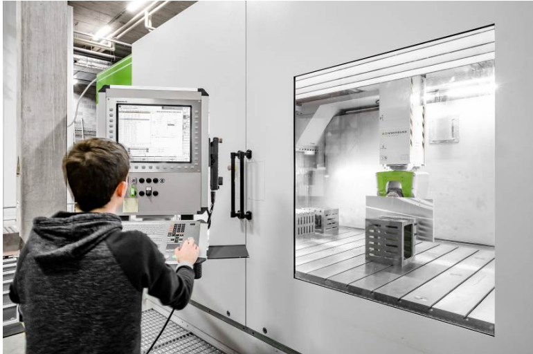
Bild 5: Um eine sehr hohe Genauigkeit der Teile zu erreichen, werden diese mechanisch feinbearbeitet.
